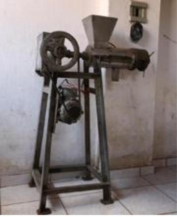
ou prensado antes de ser inserido nela, e que já separa o suco para um lado e o bagaço para o outro – o *estado da arte* dos instrumentos utilizados na produção de cajuína e sonho de consumo dos produtores locais.
