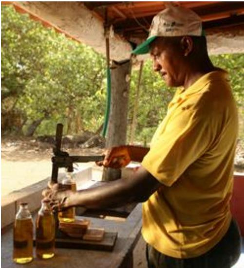
Fig. 44: instrumento para tampar garrafas.
