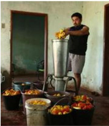
Fig. 53: liquidificador mecânico.
