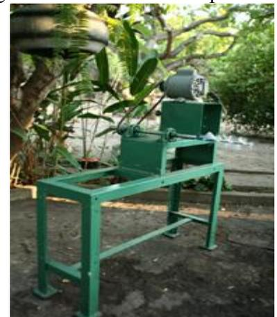
Fig. 42: máquina desenvolvida para lavar interior de garrafas reaproveitadas.
