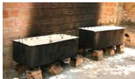
Fig. 34: Tonéis de esterilização improvisados a partir de geladeiras.
